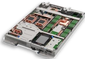
SD650-I V3 2S Intel EGS 4x Intel Ponte Vecchio
